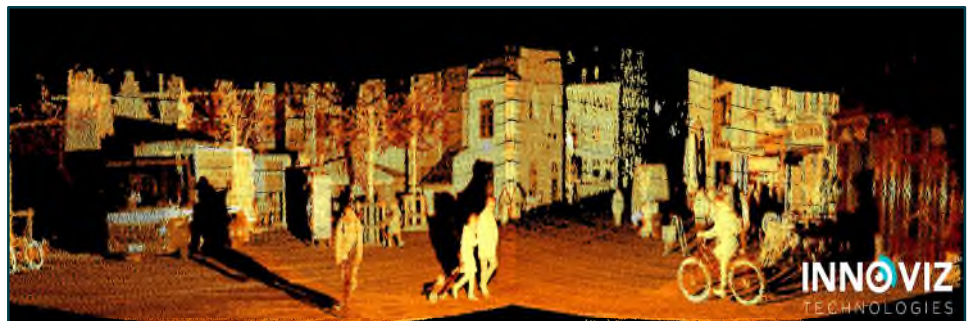
Bild 3. InnovizOne Automotive grade LiDAR. Urklipp från videomaterial som illustrerar de utdata som vald LiDAR-sensor med upplösning om 0,1x0,1 grader genererar.
